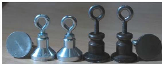
**Abbildung 1:** Mit Öse modifizierte Stempel von DFD® Instruments und Aluminiumstempel
