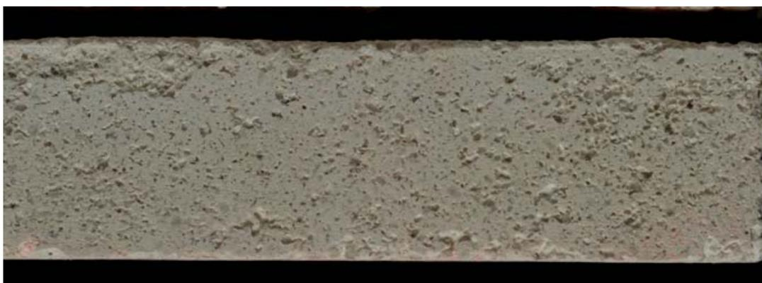
**Abbildung 7:** *Probekörper aus Aerogel und Mikrohohlkugeln*
