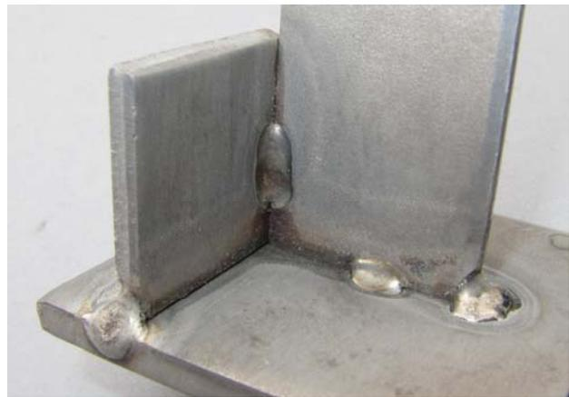
**Bild 4:** Anschweißanker nach 5 Jahren Bewitterung im Meeresklima von Helgoland (oben: Originalzustand, unten: nach Ablösen von Korrosionsprodukten in stark verdünnter inibierter Sparbeize)
