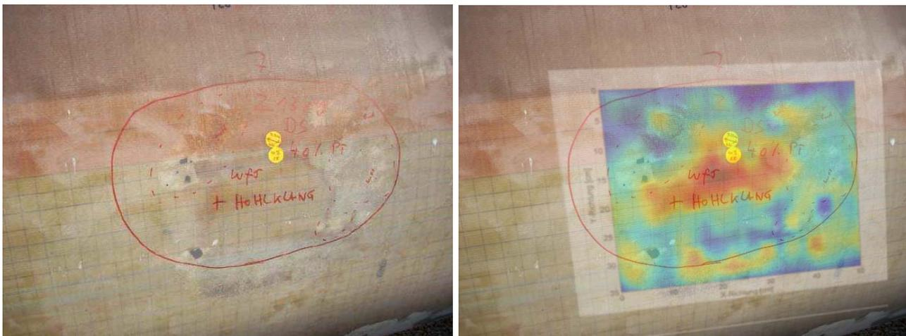
**Abbildung 4:** Links: Foto der eingezeichneten Fehlstellen im Material. Rechts: Foto der Fehlstelle überlagert mit den Ergebnissen der lokalen Resonanzspektroskopie.
