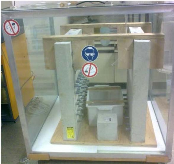
**Abbildung 1:** Prüfkammer zur Karbonatisierung
