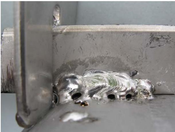
**Bild 6:** Schweißnähte von Ankern des Bauwerks 2 nach 23 Jahren im Originalzustand (oben) und nach Ablösen der Korrosionsprodukte (unten)
