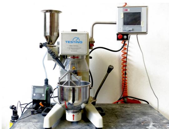
Wasseranspruch in Abhängigkeit der Fließmittelmenge im Mörtelmischer
