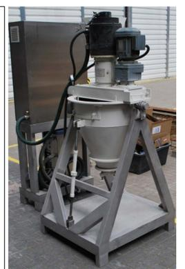
Geringerer Wasseranspruch im Konusmischer aufgrund des höheren Energieeintrags.
