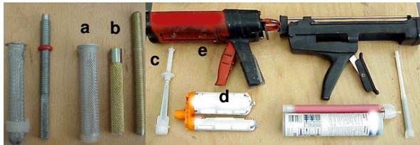
Injektionsdübel übertragen Zugkräfte überwiegend über mechanische Verzahnung des in den angeschnittenen Hohlraum gepressten Mörtels mit dem Untergrund. Zusätzlich wirken Verbundkräfte im Bereich der angeschnittenen Stege. Wird beim Bohren kein Hohlraum angeschnitten, muss eine Zugkraft über Verbundspannungen zwischen Mörtel und Bohrlochwand übertragen werden. Injektionsdübel versagen im allgemeinen durch Steinausbruch.
