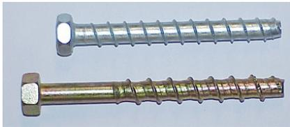
**Bild 2:** In den Versuchen verwendete Schraubdübel mit  $d_0 = 10$  mm [1]
