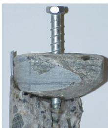
**Bild 1:** Schraubdübel in einem großen Zuschlagskorn [1]
