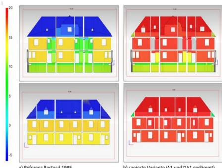
Innenoberflächentemperaturen bei  $\theta_e$  -5°C
