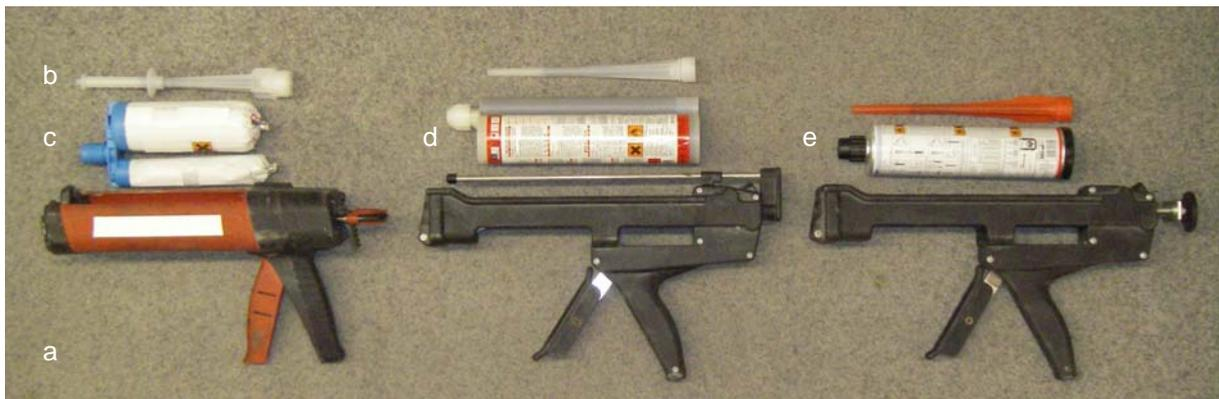
**Bild 3.7:** Komponenten von zugelassenen Injektionssystemen: Auspresspistolen (a), Statikmischer (b) und Injektionsmörtel im Doppelschlauchbeutel (c), in einer Side-by-Side Kartusche (d) oder Koaxialkartusche (e)
