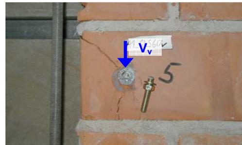
b) Spalten/ Kantenbruch mit Stahlbruch bei randparalleler Last
