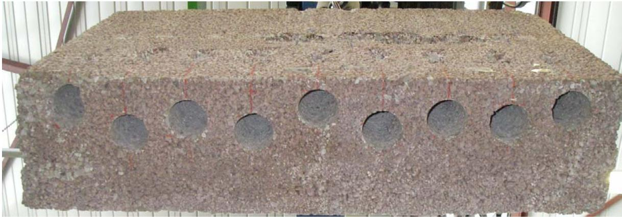
**Bild 6.2:** Mittels Kernbohrung erzeugte Lochung am Beispiel Bisotherm-Planelement PE12-2-0,5
