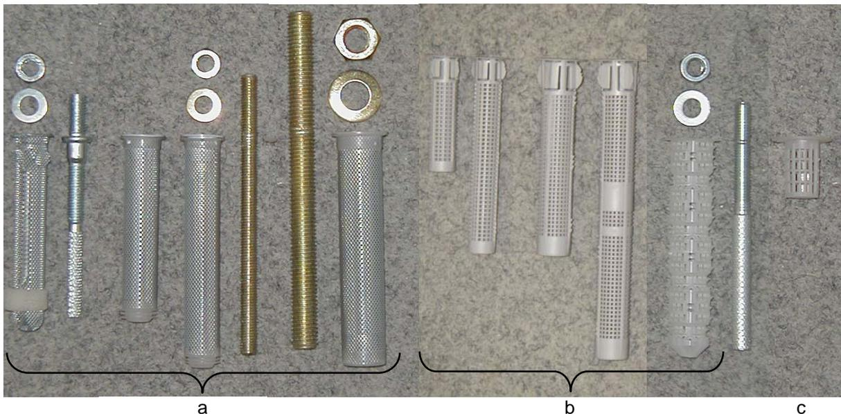
**Bild 3.8:** Dübelbestandteile von zugelassenen Injektionsdübelssystemen: Siebhülsen aus Metall (a) oder Kunststoff (b), Kunststoff-Zentriertülle (c) und Ankerstangen mit Unterlegscheiben und Muttern
