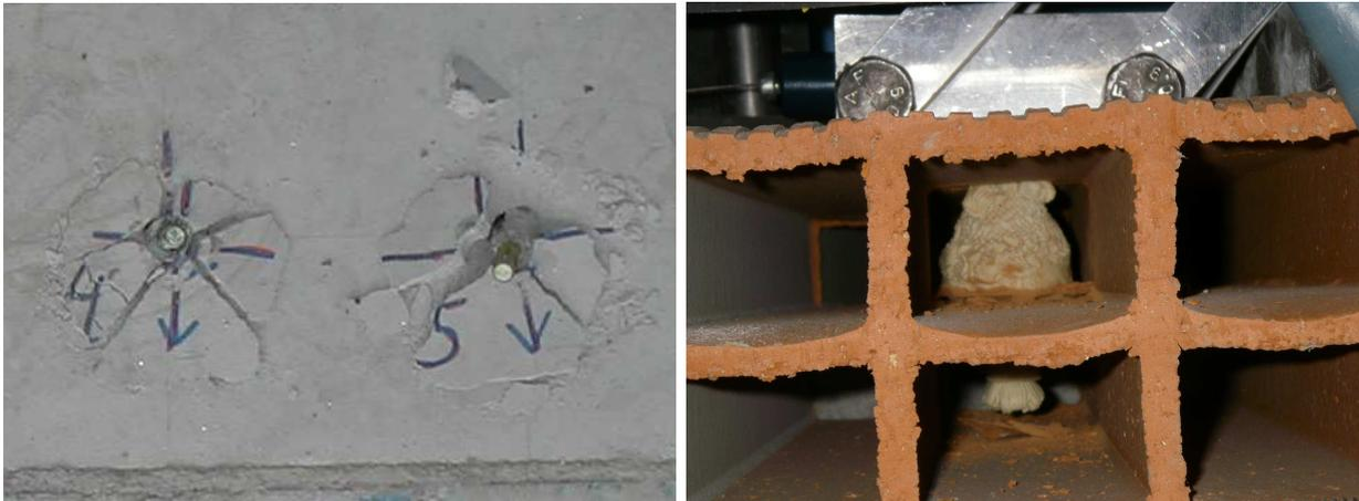
a) Dübel M10Ø16-50 mm mit Metallsiebhülse in Ksl12-1,2-16DF bei Verankerung im Außensteg
