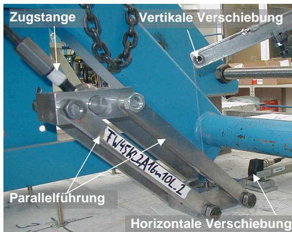
a) Parallel geführtes Anbauteil ( $45^\circ$ )
