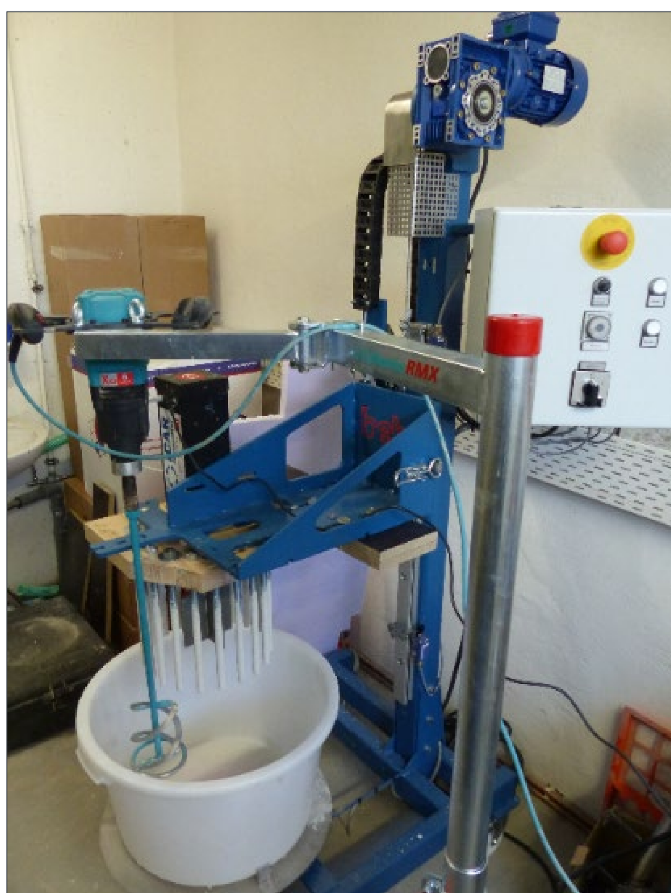
Versuchsaufbau zur Vorscherung ohne Entmischung und Messung der rheologischen Parameter von Beton
